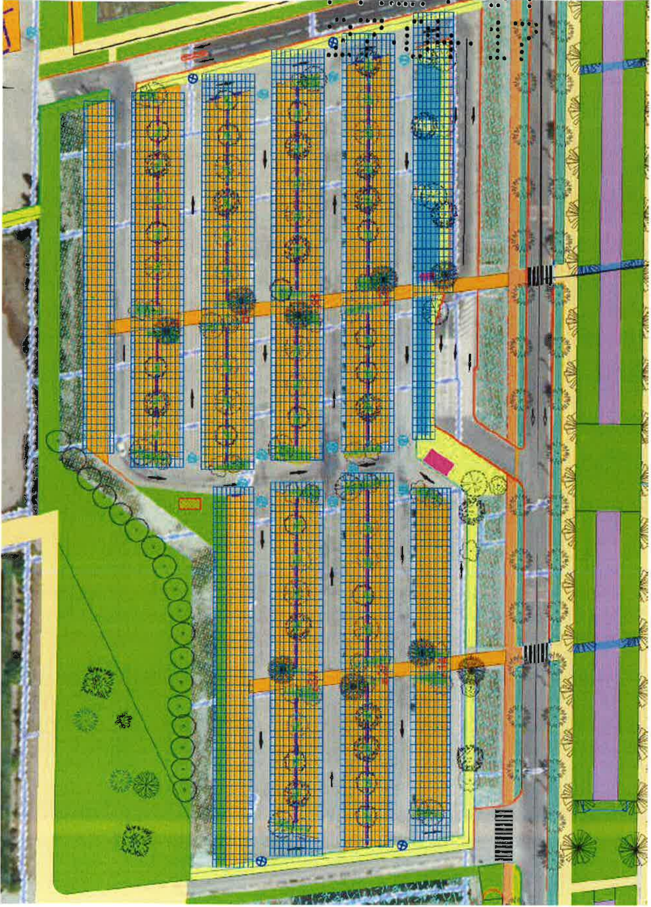
ANNEXE 2 – PLAN DE LA CENTRALE PHOTOVOLTAÏQUE PROJETÉE SUR LE PARKING P1 À BEAULIEU
